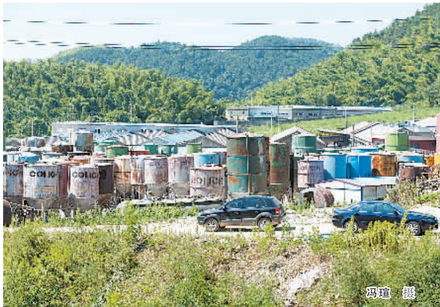
空地上耸立着大大小小新旧不一的水泥罐，低的四五米，高的六七米。
