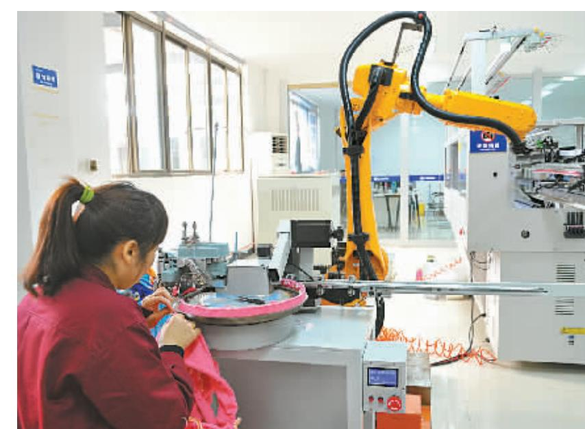
慈星研发的毛衫自动对目缝合机器人突破了传统毛衫缝合只能通过繁琐的人工视觉对目的瓶颈。图为机器人与工人进行比赛。结果机器人仅用人工1/3的时间完成同一款毛衣缝合。
