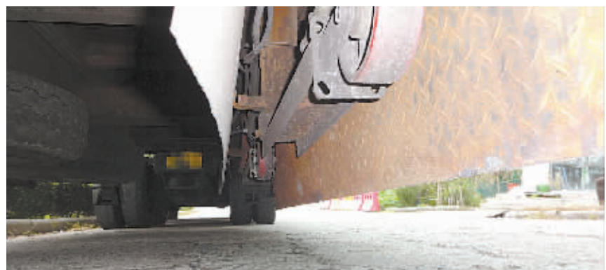
▲挂车底部的伸缩液压装置。右侧为遮挡视线的铁皮,铁皮后面藏着滑轮,启动后滑轮放下支撑地面,起到分担重量的作用。
