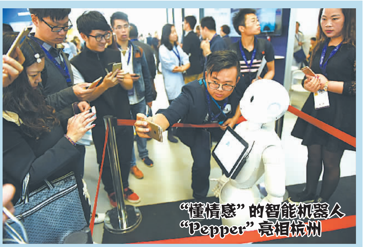
10月14日，参观者与智能机器人“Pepper”互动。当日，由阿里巴巴、软件银行集团、富士康科技集团共同投资研发的智能机器人“Pepper”现身2015杭州云栖大会，吸引了众多与会者的目光。据介绍，机器人“Pepper”具备“情感”，其头部装有麦克风、摄像头和3D传感器，对人的表情、声调均可识别，可根据人类情绪进行反应。
