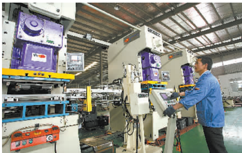
先锋电器工人正在操作已投产的全自动冲压流水线。(徐能摄)
