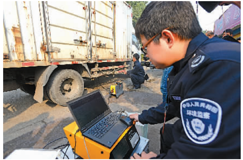
昨天上午，执法人员正在对一辆疑似超标卡车进行尾气检测。(记者 徐能 摄)
