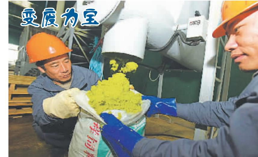
昨天，宁波渤海液处置有限公司员工在将从废盐酸中回收的氯化亚铁晶体装袋，其产品可用于处理废水、污水。据了解，该公司为全市首家对废酸液、废乳化液进行收集、处理并加以利用的企业，年处理能力37万吨，其产品在保护环境、节约资源、降低生产成本、实现变废为宝上可发挥积极作用。（徐文杰 沈颖 摄）
