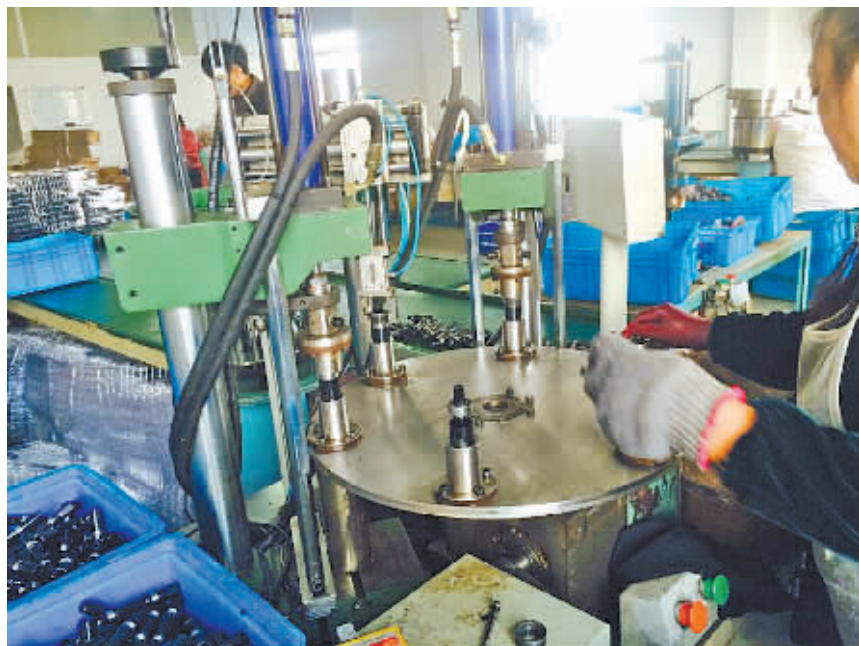
图为工人正操作机械手生产自行车中轴。(项一嵌 摄)
