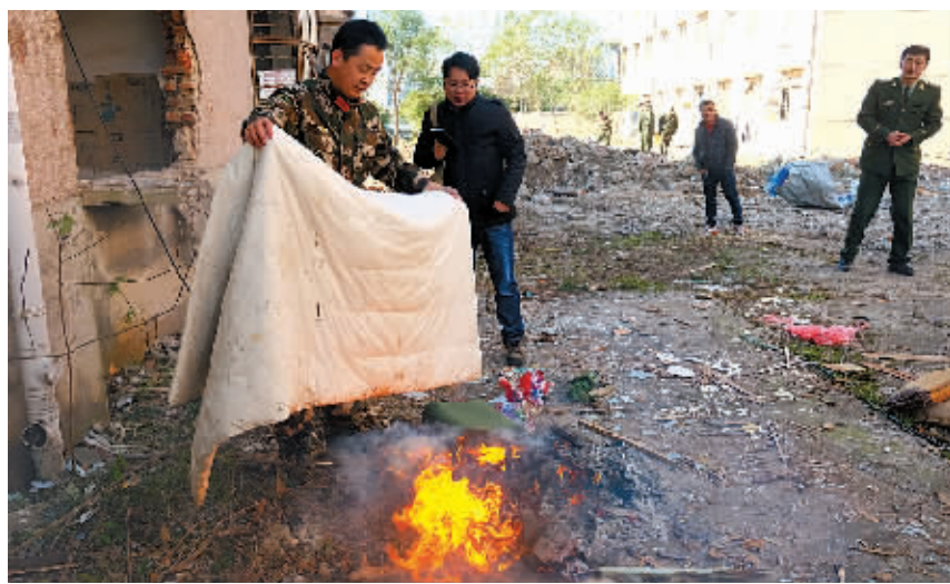
实验人员测试湿棉被抵御明火的情况。
