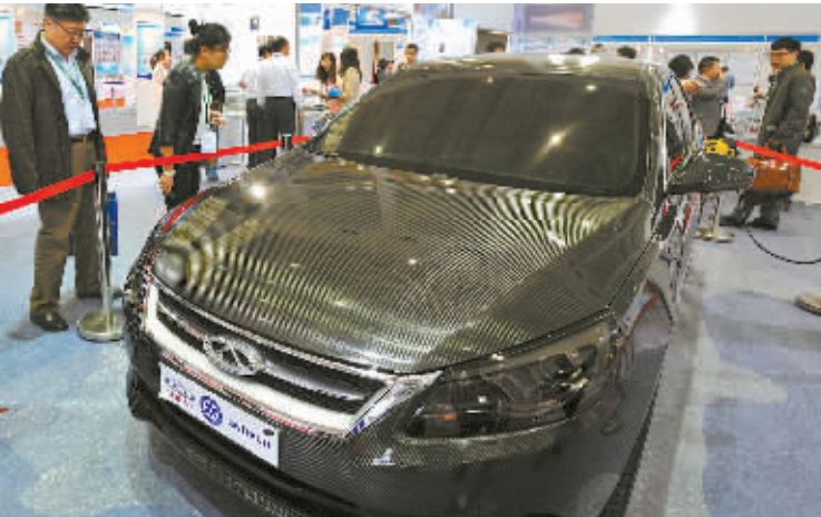
图为中科院宁波材料所与奇瑞合作成功的国内首款碳纤维复合材料电动车。
