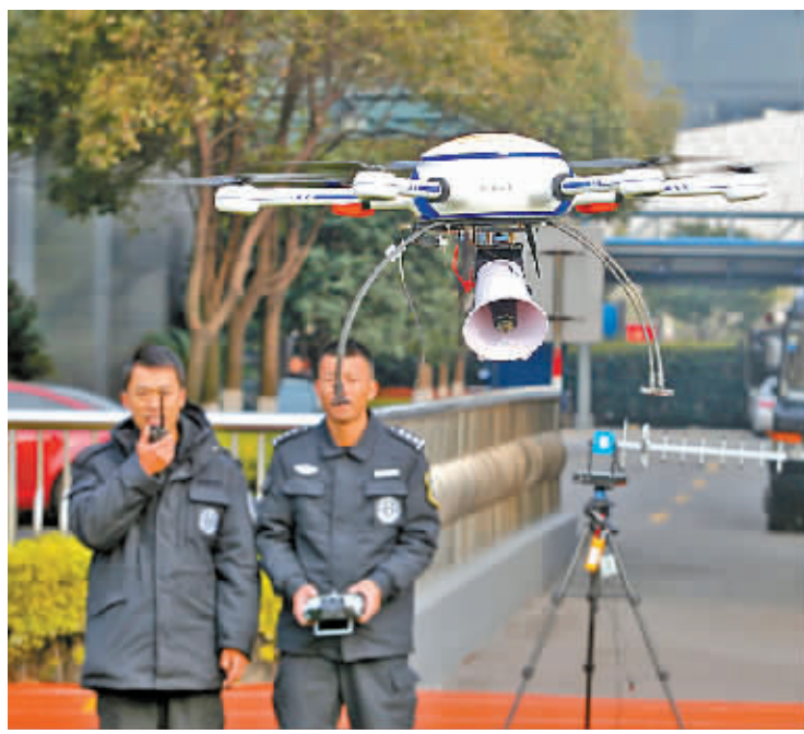
警方新装备的一架无人机可加载夜视仪、红外线、毒气分析仪等设备。(周维强 摄)
