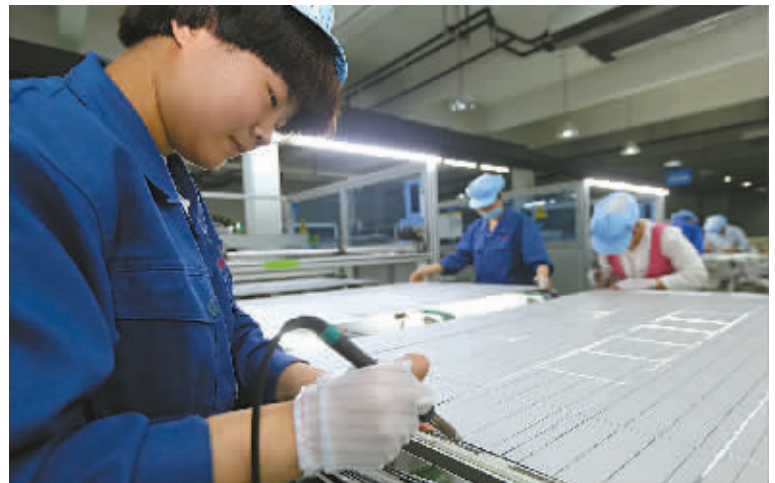
图为员工正在焊接太阳能电池板。
