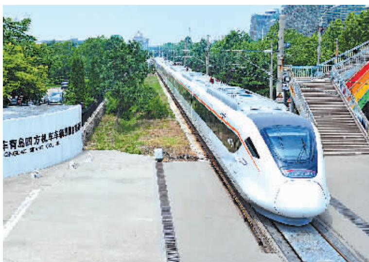
CRH6F型城际动车组在厂区试验(资料照片)。
