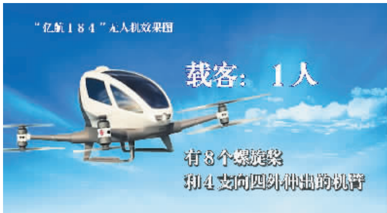
“亿航184”无人机效果图 载客:1人 有8个螺旋桨和4支向外伸出的机臂 少专家感到兴奋。 “亿航184”的寓意是这种无人机能运载1位乘客,它有8个螺旋桨和4支向外伸出的机臂。其外观与直升机类似,可实现完全自动驾驶。亿航公司表示,希望这款无人机将来成为人类中短途日常交通工具。
