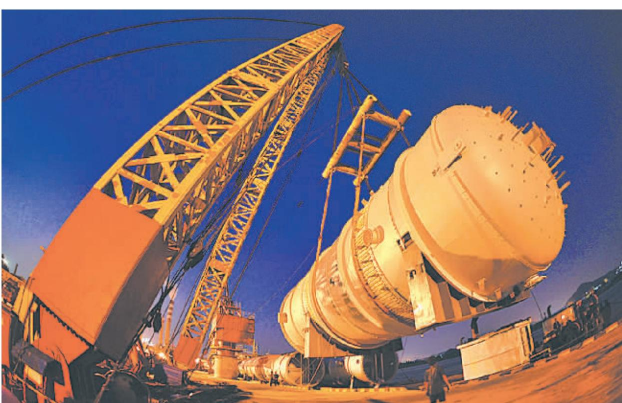
炼化工程集团宁波工程公司承制的俄气石油鄂木斯克炼油厂常减压蒸馏装置首批设备近日完工，并于7月24日到28日在镇海大件码头装船启运。这是甬产石化设备首次出口俄罗斯。该批订单共有8台非标设备，总重量1075吨。图为长23米、重134吨的原油闪蒸罐正在装船。
