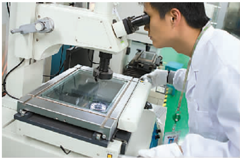
技术人员进行插座高温变形检测。
