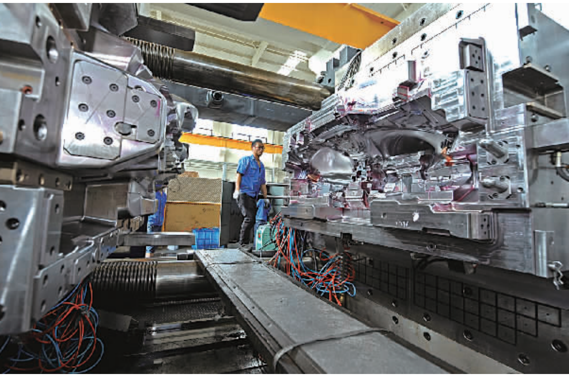
昨天下午,位于宁波桃源街道的宁波方正汽车模具有限公司高速铣精加工车间,工人正在通过智能化设备加工模具顶块...
