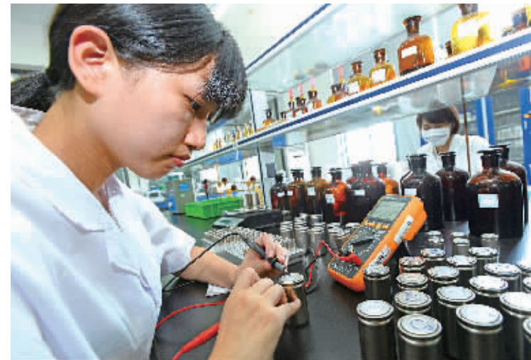
昨天上午,在宁波倍特瑞能科技有限公司独立研发设计中心,技术人员正在进行新型电池电压稳定性测试。自2010年成立以来,公司每年投入2000余万元资金,成功研发多条先进无汞碱性电池流水线,目前已成为行业细分领域的领头羊。(徐能 张琦 摄)
