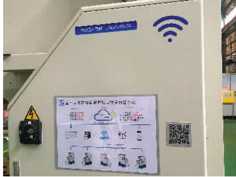
金丰机械的冲床产品自带无线通信模块。
