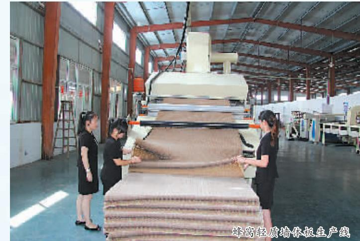
近几年，在位于象山农村地区的宁波振和新型墙体材料有限公司，可以看到车间一片繁忙的景象：从原料进厂到产品出厂，全线经过精心设计，全程实现机械化生产，特别是6台运行稳定的机械手两次码坯，大大提高了生产效率和产品质量。生产线利用生物质燃料和废炉渣残余热量供热，并投资60万元引进湿法脱硫工艺，脱硫效率大于90%，排放烟气达到环保要求。“我们的生产线年产能达8000万块标
