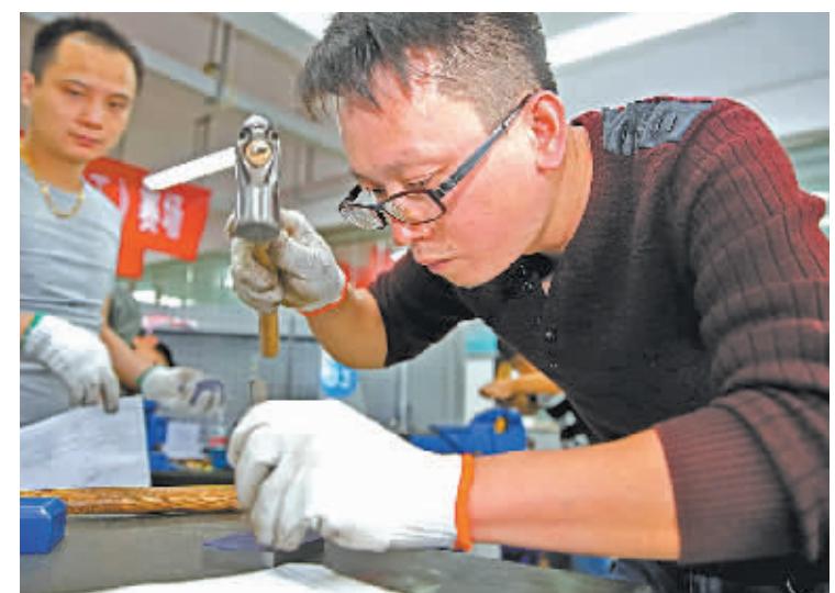
昨天,市人社局、鄞州区人社局、鄞州职教中心联合举办2016年宁波“技能之星”职业(工具钳工)技能大赛,百余名企业技工与技校师生共同参加。在比赛现场,选手们通过审图、划线、锯割、锉削、钻孔等道工序,精雕细琢完成金属零件。据介绍,获得比赛前3名选手将被分别授予市技能之星、市技术能手称号。(徐文杰 王亚达 摄)
