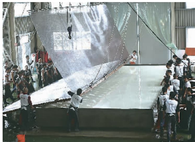
近日,位于“中国宣纸之乡”安徽泾县的中国宣纸股份有限公司再次启动“三丈三超级宣纸”的抄制。“三丈三超级宣纸”成品纸尺寸达11米×3.3米,是真正意义上的传统、手工、二帘水的“超三丈三”宣纸,主要适用于创作巨幅书画艺术作品。(新华社发)
