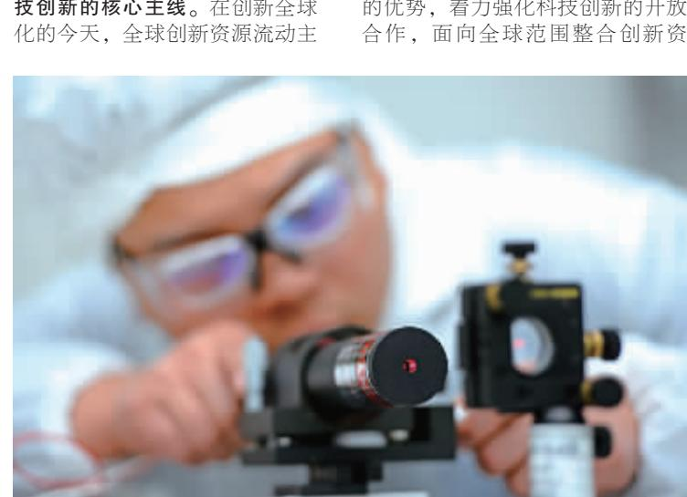
在宁波中物激光与光电技术研究所的超净间光学实验室里，国内首台自主研发的民用激光冲击强化平台组装完成。
