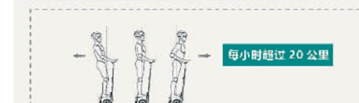
试验结果还显示了电动平衡车车速过高的问题。20个样品中，16个样品行驶的最高车速超过每小时20公里。而根据相关标准，电动自行车的最高车速也只能是每小时20公里，但试验中最快的电动平衡车已经达到每小时27公里。
