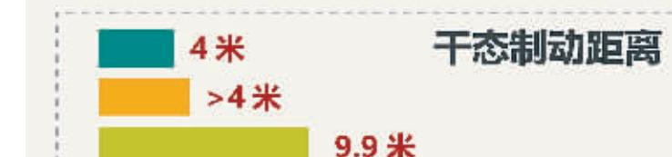
电动自行车车轮直径为35厘米至60厘米，而电动平衡车车轮直径约为20厘米。因此电动平衡车刹车时摩擦系数小，稳定性较差，制动距离较长。
