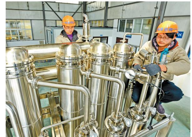
近日，位于象山晓塘的宁波和信制药设备有限公司组装车间内，技术人员正在检测即将运往印度的新型多效蒸馏水机。据悉，该款蒸馏水机采用多项自主创新技术，能有效降低能源消耗、提高蒸馏水品质、减少微生物污染风险等，填补了国内多项技术空白。（徐能 励建挺 摄）
