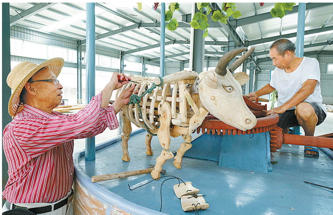
把一个个纯手工制作的原木配件组合成牛力水车。
