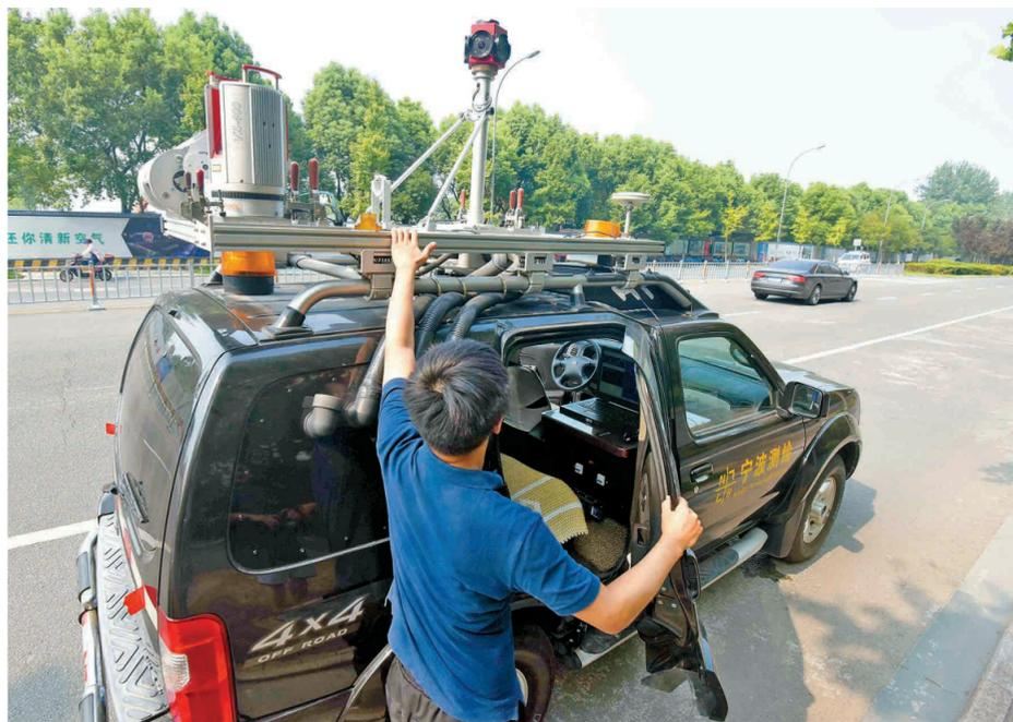
宁波市测绘设计研究院的车载移动测量系统。
