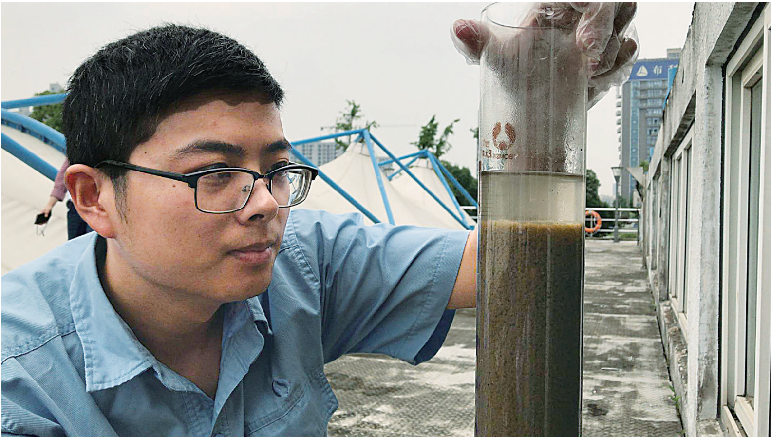
污水处理厂生物反应池里打出来的污水。
