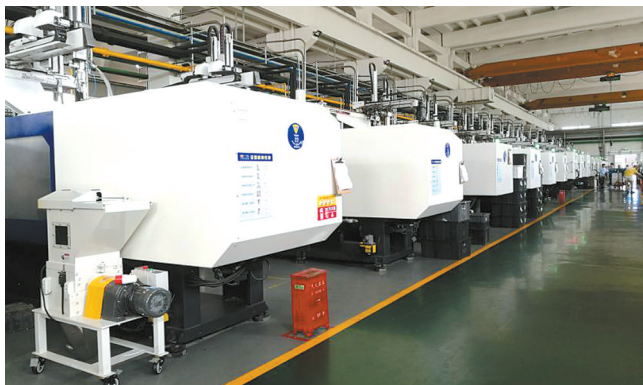
先锋注塑造化生产线。
