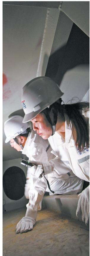
交通港航“蓝水滴”又在闷热又热的双层船底内检验作业
