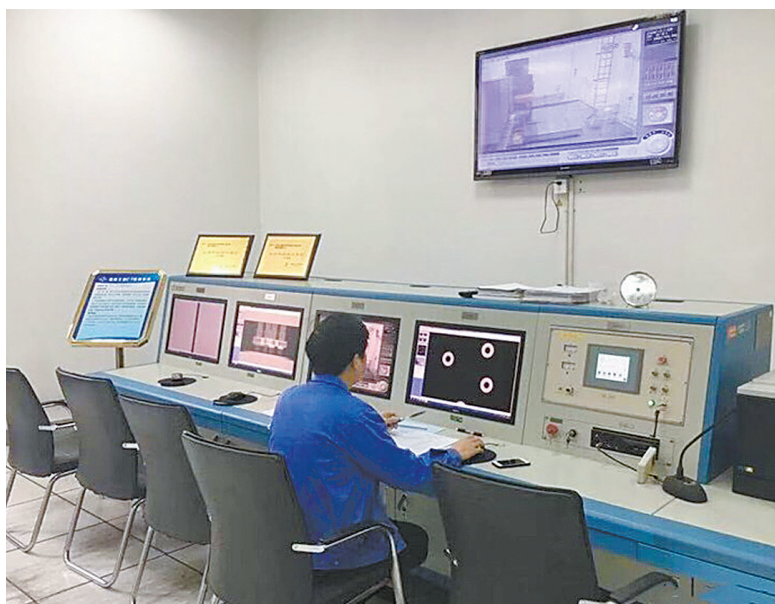
中科院宁波分院技术人员正用工业CT检测仪器对嫦娥四号关键阅体进行检测(资料图)。(金鹭 丁彦婷 摄)
