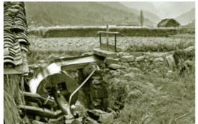
1996年尚在使用的余姚原梨洲乡的水碓子。左边主出水口用于冲水轮，右边副出水口用于减水调节，中间细长的小出水是防止轴头发热的。
