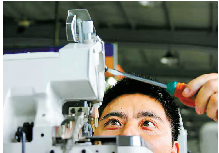
德鹰工人正在调试旋梭。(李超 摄)
