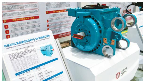
这是9月17日拍摄的时速400公里高速动车组用TQ-800永磁同步牵引电机。当日,中车株洲电机公司发布了时速400公里高速动车组用TQ-800永磁同步牵引电机。这
