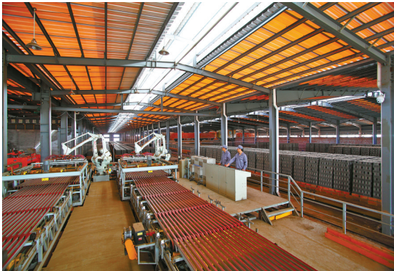
非黏土烧结砖生产线。
