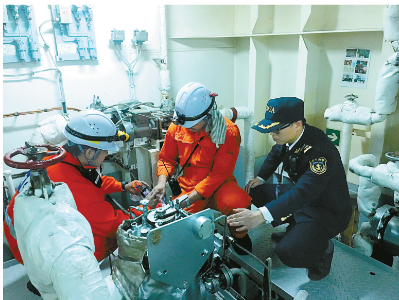
海事执法人员与船员在船舶机舱内抽取燃油样品。(董娜 麻宏宇 摄)
