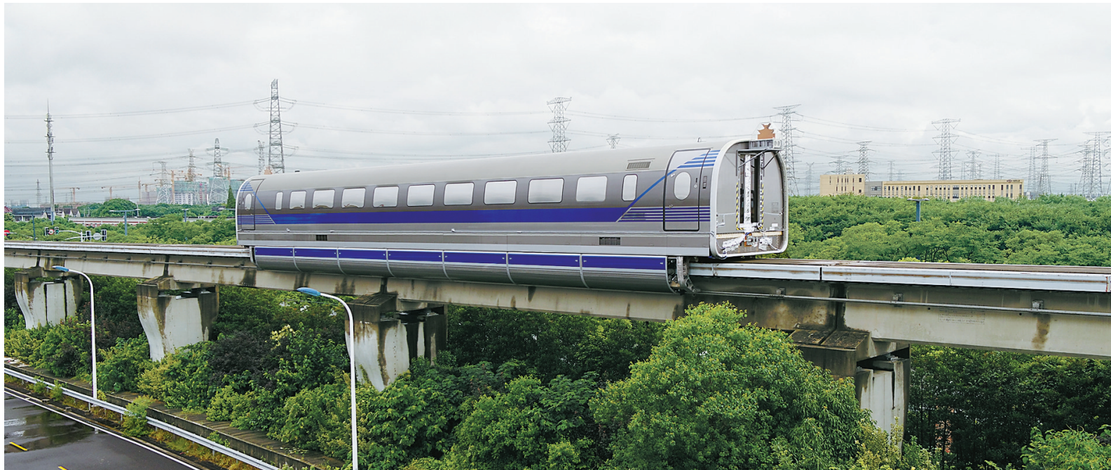
6月21日，时速600公里高速磁浮试验样车在磁浮试验线上试跑（无人机照片）。（新华社发）
