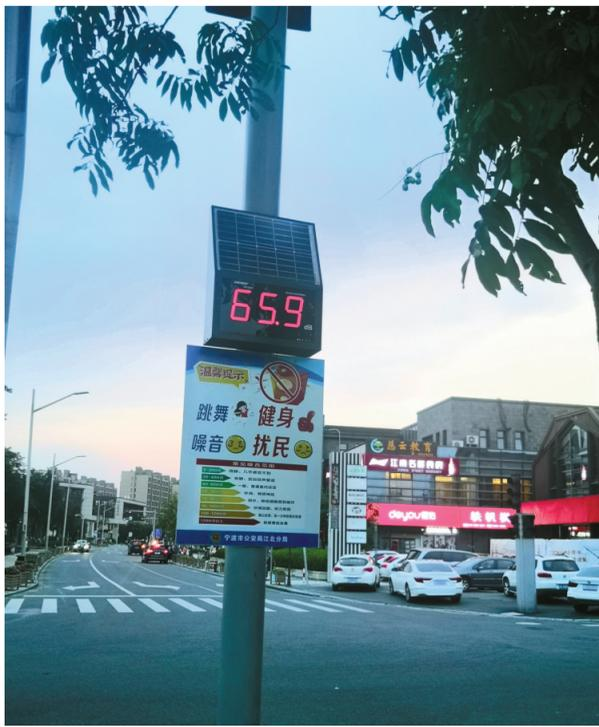
太阳能噪声监测仪能根据光线变化自动启动,实时监测音量。(王晓峰 杨照瑾 摄)
