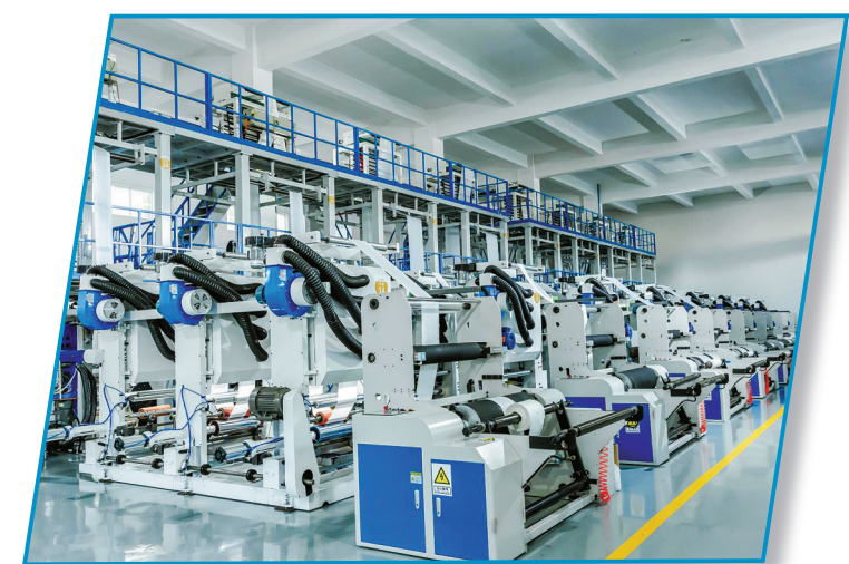
宁波家联科技全降解塑料袋自动化生产流水线。(王岚 摄)
