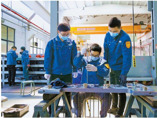
宁海县兴利汽车模具有限公司技能导师白颖（右）带领实习生给汽车注塑模具配顶针板。（虞晓帆 摄）
