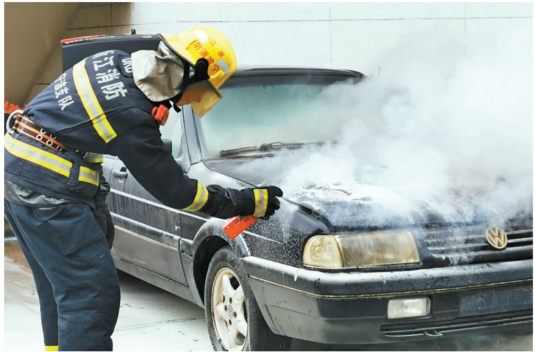
消防员对闭合引擎盖使用灭火器。
