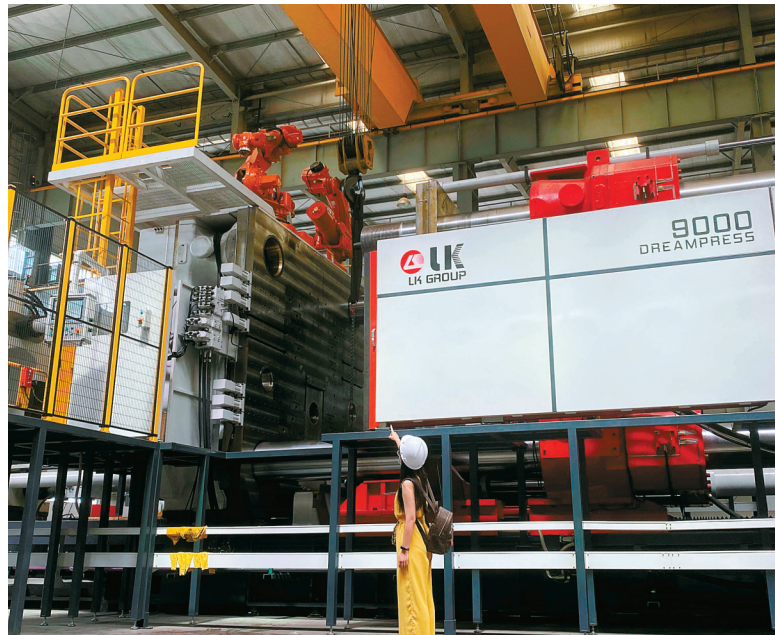
“力劲 Dreampress 9000T” 高约两层楼，重量超过400吨。 (殷聪 摄)
