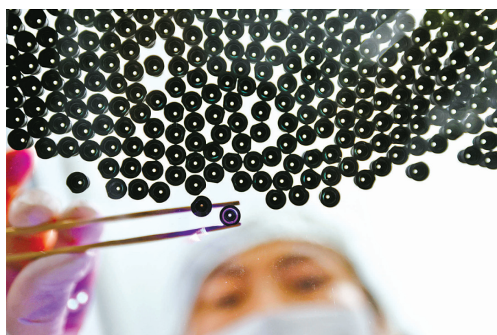
工作人员正在对镜头进行检测,他们生产的最小镜头直径小于1毫米。
