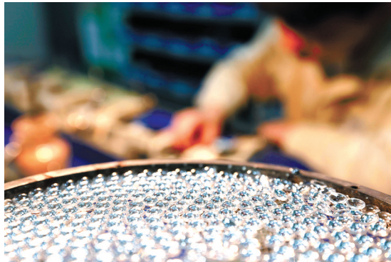
工作人员正在用古典法抛光技艺对一些特殊镜片进行手工抛光。
