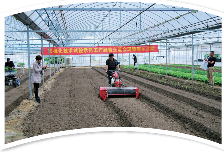
多功能起垄整地机作业现场。
