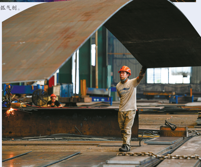
下料工人正在吊运钢板。
