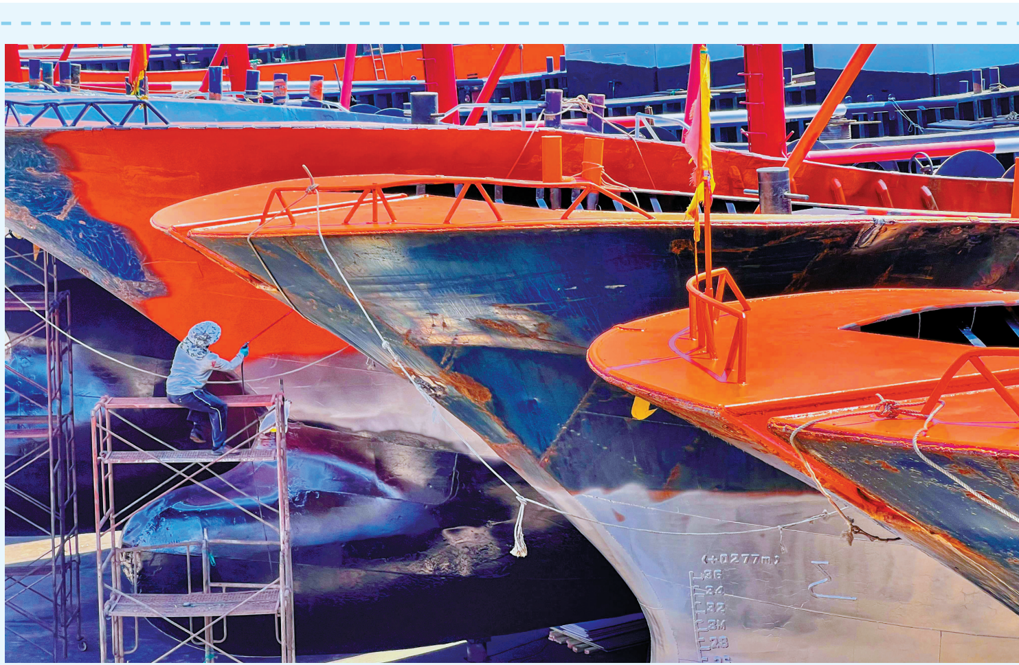
伏季休渔期即将全面结束，8月23日，处暑时节，甬城持续高温，记者在奉化莼湖一家船舶修造厂看到，工人们正顶着酷暑为渔船除锈、刷漆、保养，准备迎接新一轮的开渔捕捞工作。（唐严 董惊鸿 摄）
