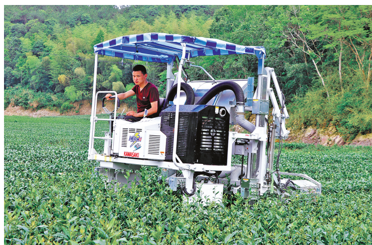
昨天,在宁海县胡陈乡平水庙元林茶基地,工作人员驾驶着乘坐式茶园管理机进行茶园修剪工作。这是宁海国元茶叶有限公司引进的宁波市首台多功能乘坐式茶园管理机,集修剪、采茶、修边等功能于一体。据介绍,有了这台机器,这几天工作人员修剪茶园的效率大大提高,人工成本能节省三分之二。(孙吉晶 仇丹妮 吴帅 摄)
