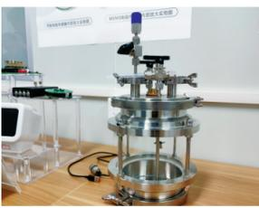
高性价比新型传感器测试腔。(沈晔晖 张超梁 摄)
