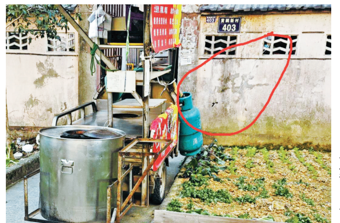
鄞州区黄鹂新村内一辆小摊车正在飞线充电，车辆一侧悬挂着燃气气瓶。（邱韵 摄）
