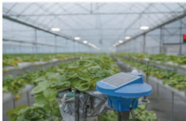
草莓,是这个农场的龙头产品,不同生长阶段的土壤湿度要求不同,湿度传感器可以精准把握。
